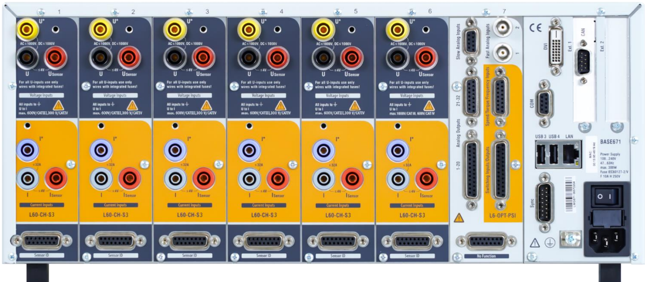
Abb. 2: Rückansicht eines LMG671 mit 6 S3-Kanälen
